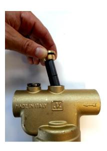
La tenuta del tappo della cartuccia magneto avviene tramite O-ring sulla battuta e non necessita di sigillanti o teflon; coppia di serraggio max: 15 Nm.
